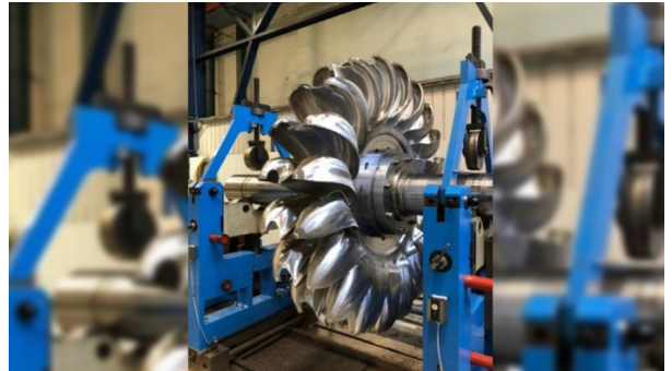
Turbine type Pelton de la centrale électrique( zinfos 974)
