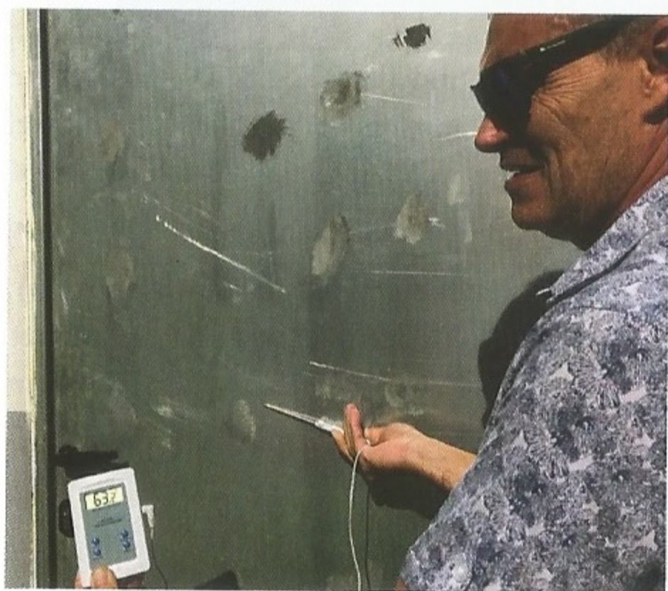
Figure 3 - Température de la porte.
