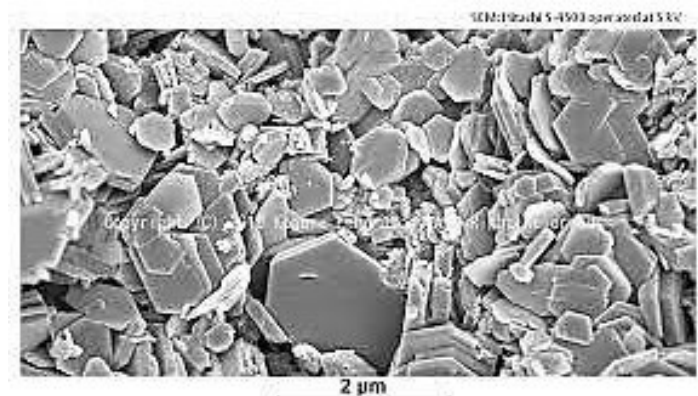
Document 2 : Observation d'argile Kaolinite au microscope électronique (x20 000)
